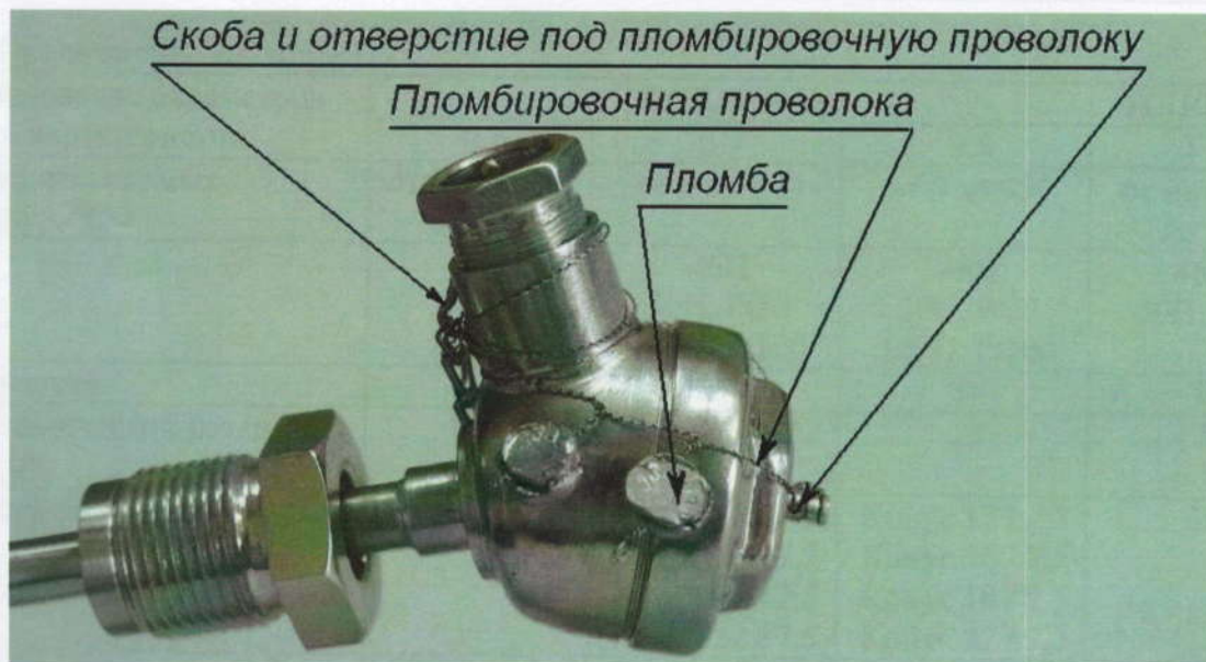
Рисунок 2 – Схема пломбирования термометров сопротивления с металлическими головками
